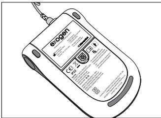
2. Retournez l'EXOGEN de façon à ce que l'écran soit dirigé vers le bas. La vis de la porte du compartiment de la batterie est située sur cette face du dispositif.
