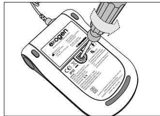
3. Retirez la vis de la porte du compartiment de la batterie à l'aide d'un tournevis.
